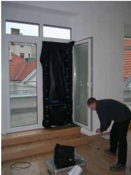
Abbildung 4: Blower Door Messung
